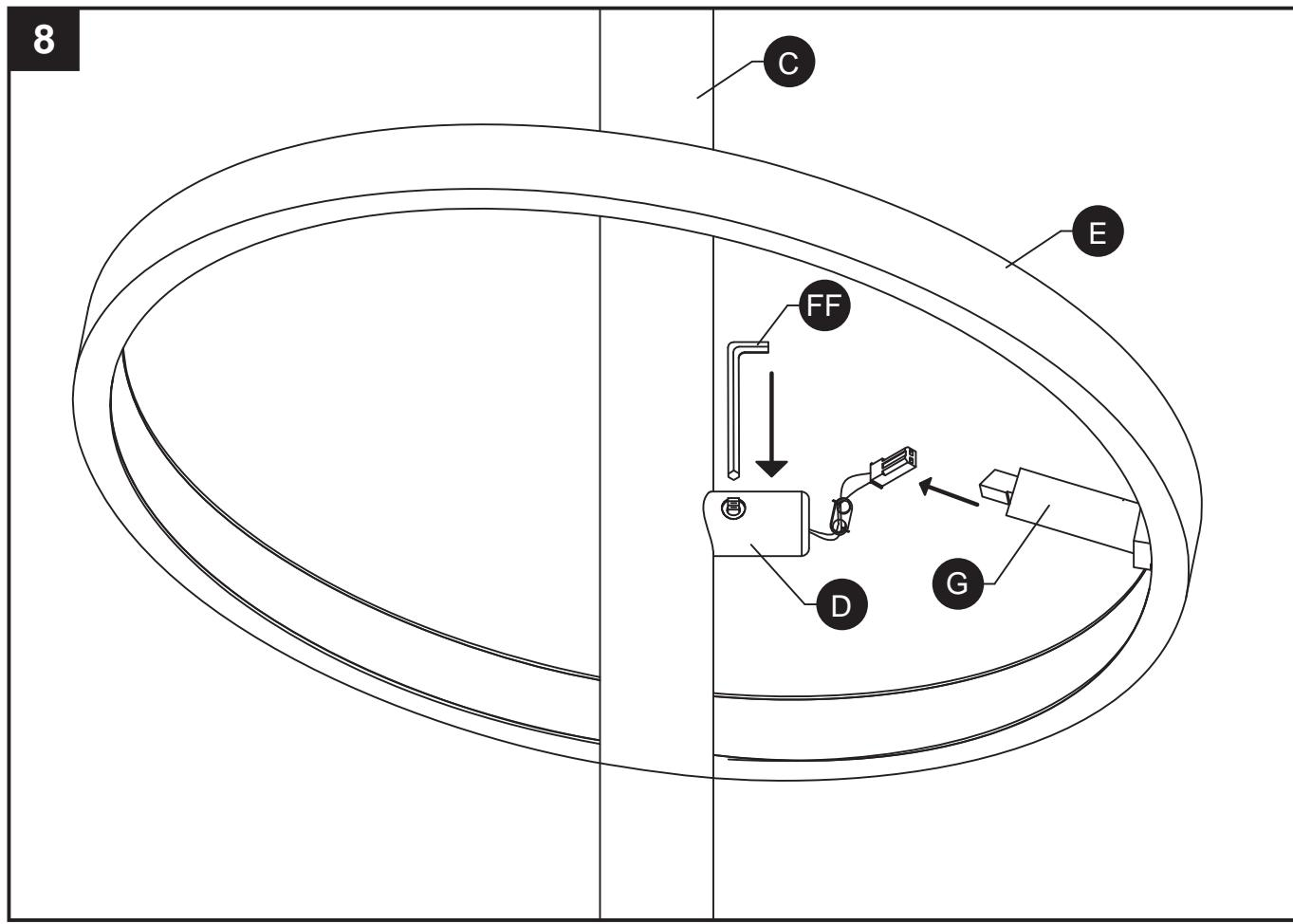
8. Placez le petit anneau à DEL (E) sur le corps du luminaire (C). Connectez le câblage du bras (D) à l'émerillon (G). Insérez l'émerillon (G) dans le bras (D) et fixez à l'aide de la vis de réglage en utilisant la clé Allen (FF). Répétez cette étape pour l'anneau moyen à DEL (H) pour le grand anneau à DEL (F) et pour le très grande taille anneau à DEL (L).
