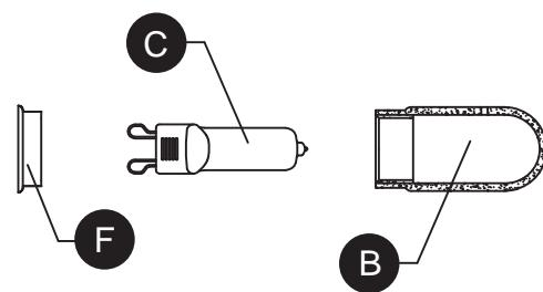
4. Placez l'abat-jour (E) sur la douille filetée (D) et fixez-le à l'aide de la bague de douille filetée (F). Insérez une ampoule G9 de 25 watts (C) dans la douille filetée (D). Vissez le cache-ampoule (B) sur la douille filetée (D).
