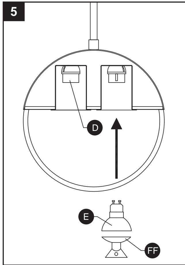
5. Insérez deux ampoules GU10 de 35 watts (E) dans les douilles (D) à l'aide de la clé (FF).
